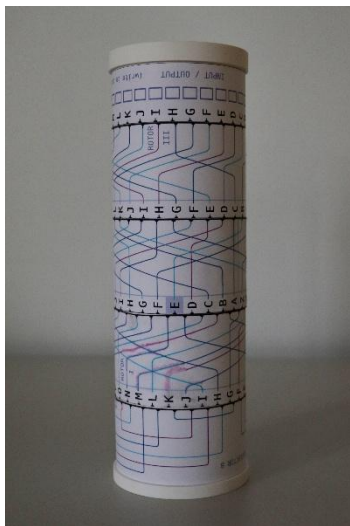
Rysunek 4. Zbliżenie na schemat ścieżek sygnałowych, pokazujące mechanizm zamiany poszczególnych liter alfabetu wewnątrz systemu wirników
