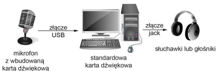
Rysunek 3 Schemat podłączenia sprzętu audio do komputera- wariant 1
