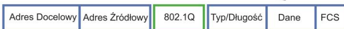
Rysunek 4 Struktura ramki Ethernet II, ramki protokołu ISL oraz standardu znakowania IEEE 802.1Q
