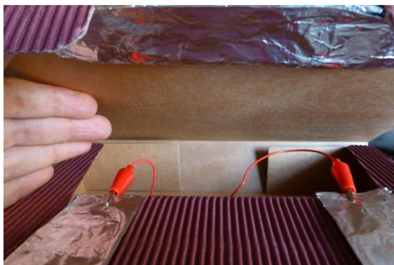
Rysunek 9 Wnętrze sejfu – po zamknięciu pokrywy górna folia aluminiowa tworzy obwód zamknięty z dwoma bocznymi
